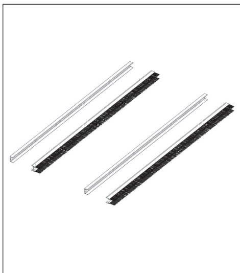
7. Нижний и верхний алюминиевые профили с щеточным уплотнителем
